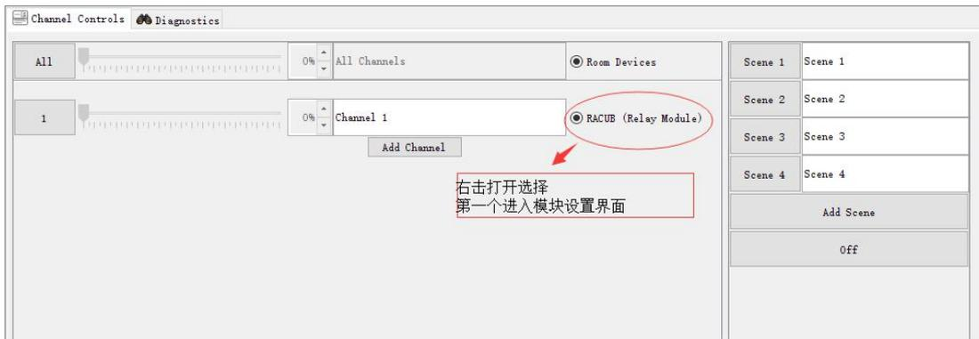
11、 进入该界面后，可以对该模块进行相应的设置。在界面中可以设置电机的正反转时间，还能够测试惦记的正转反转。如图，
